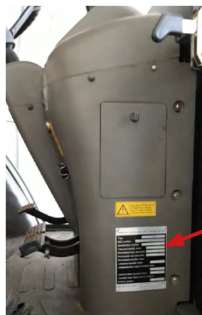
"CAB-NAMEPLATE" FØRERHUS - TYPE- SKILT Placeret på venstre førerør
